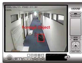
Cizí objekt zaznamenaná nežádoucí objekt ve vyznačené oblasti
